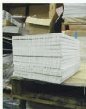
テストで抜いたもの。一部断面がが さついたり、表紙の紙が向けたと ころがあったため、抜き型などを調整 して本番に臨む
