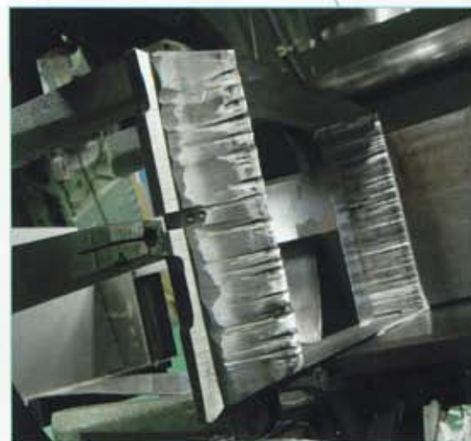
セットされた抜き型。凹凸が怪しく光りかっこいい！ こちら側から製本された本を入れ、抜いていく
