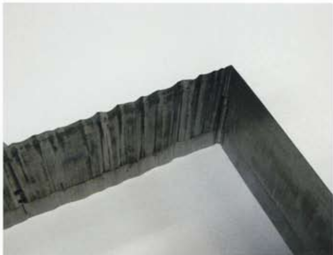
刃のアップ。栄光シボ加工の針さんが手曲げでつくってくれたもの
