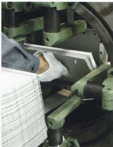
抜き型の向こう側から圧力をかけると、本が抜かれてで てくる。そのとき「チェーン！」というすごい音が
