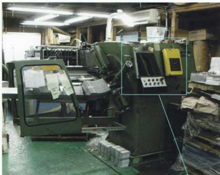
本の型抜きをするプッシュ抜き機。通常A5サイズ程度までしかプッシュ 抜きできない機械がほとんどだが、成頁紙工ではA4サイズまで抜けるのだ！
